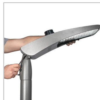
Kąt nachylenia można regulować na miejscu zarówno dla konfiguracji przy montażu bezpośrednio na słupie (0 do 10°) jak i bocznego (0 do 15°).
