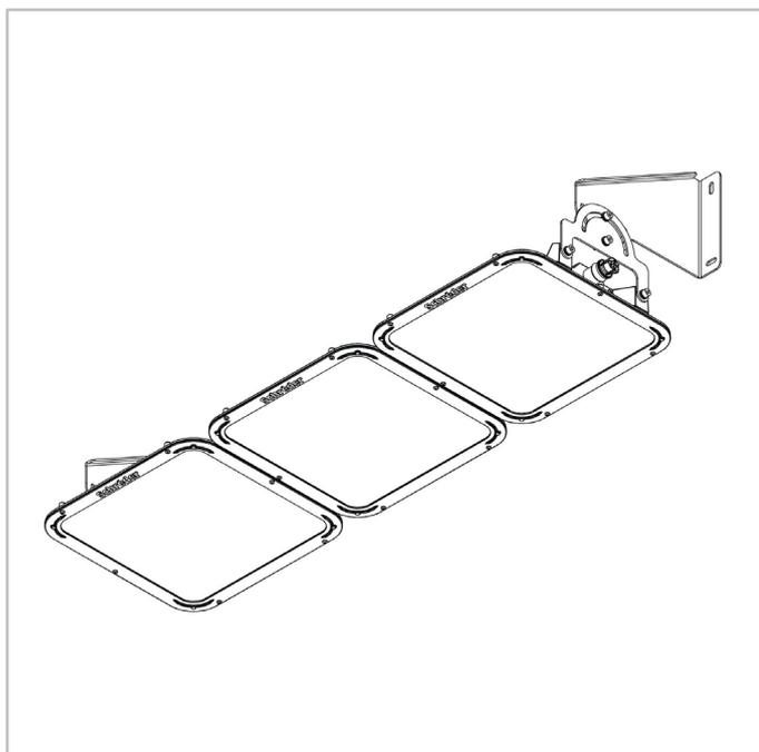
TFLEX MODULE | Fixations à crochets – Pour plus de details, veuillez consulter l'installation sheet
