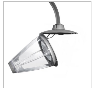
FLEXIA DP incorpora un seccionador eléctrico instantáneo en la apertura y un motor LED completo desmontable sin herramientas.
