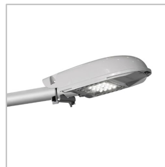
Możliwość precyzyjnej regulacji kąta pochylenia. Regulacja kąta nachylenia w zakresie od -15° do +5° przy montażu na wysięgniku oraz od -10° do +10° przy montażu bezpośrednio na słupie (adapter).
