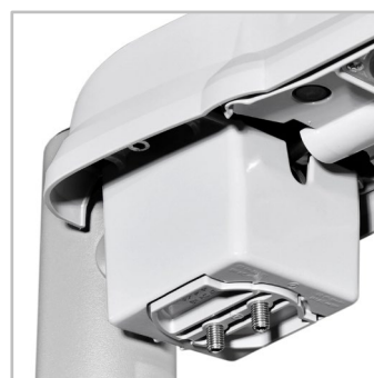
AXIA 3 EVO dispune de o piesă de fixare universală pentru ștuț cu diametrul între Ø32 și Ø76 mm. Acesta poate fi reglat la fața locului în trepte de 2,5° pentru a furniza cantitatea exactă de lumină și a optimiza fotometria.
