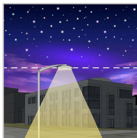
O rácio de luz para cima (ULR) e o rácio de saída de luz para cima (ULOR), este último tendo em conta o fluxo da luminária, fornecem informações sobre a percentagem de luz emitida em direcção ao céu. Esta gama de luminárias Schröder minimiza ou elimina (dependendo das opções) o fluxo luminoso para cima. Cumpre os rigorosos requisitos internacionais e locais.
