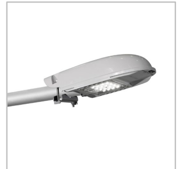
Präzise Anpassung vor Ort. Der Neigungswinkel kann von -15° bis +5° für die seitliche Montage und von -10° bis +10° mit dem Mastaufsatzadapter eingestellt werden.
