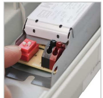
A világítótest drivere DIP kapcsolóval is szerelhető, így a világítás a helyszínen szabályozható, hogy bármilyen helyzethez igazítható legyen.
