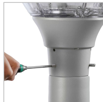
HAPILED tiene un montaje deslizante sobre una espiga de 60 mm de diámetro con 6 tornillos M6.
