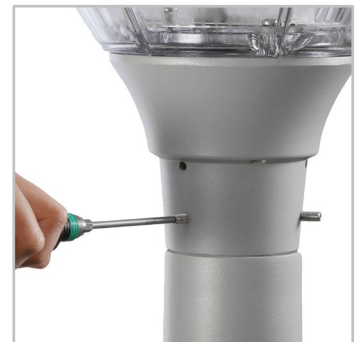
Die HAPILED ermöglicht die Mastaufsatzmontage auf einem Stutzen mit 60 mm Durchmesser mit sechs M6-Schrauben.
