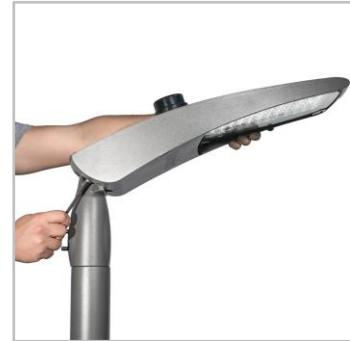
Ugao nagiba se može podešiti na licu mesta, kako pri montaži na vrhu stuba (0 do +15°) tako i pri bočnoj montaži (0 do -15°).
