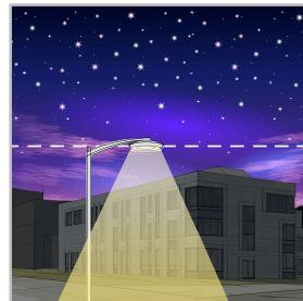
Upward Light Ratio (ULR) i Upward Light Output Ratio (ULOR) pružaju informaciju o procentu svetlosnog fluksa svetiljke koji se emituje u gornju hemisferu (ULR) i procenat svetlosnog fluksa izvora/LED modula koji se emituje u gornju hemisferu (ULOR). Schréder-ove svetiljke minimiziraju ili čak eliminiraju (u zavisnosti od opcija) svetlosni fluks koji se rasipa nagore (u gornju hemisferu ka nebu). U skladu je sa strogim međunarodnim i lokalnim zahtevima.
