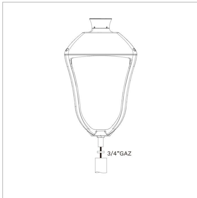
СТИЛЯЖ | Вінцеве кріплення з трубною різьбою 3/4"
