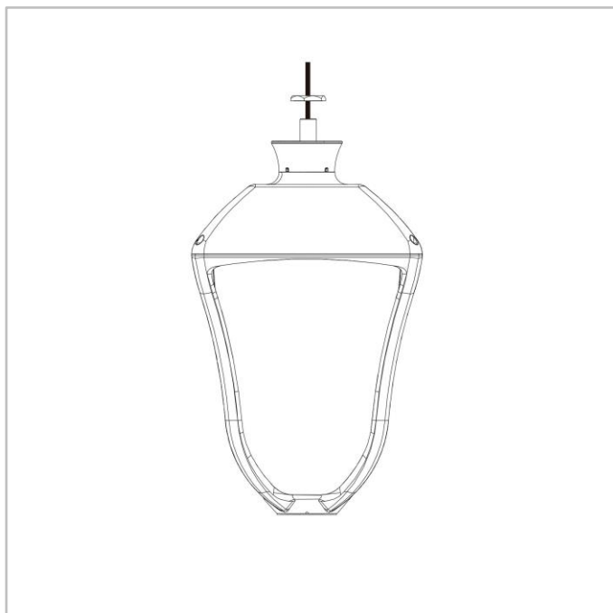
СТИЛЯЖ | Підвісне кріплення з внутрішньою різьбою 1" або зовнішньою 3/4"
