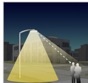
Vzhledem k nižší montážní výšce ve srovnání se silničním osvětlením je vizuální komfort základním aspektem městského osvětlení. Společnost Schréder navrhuje čočky a příslušenství tak, aby minimalizovala jakýkoliv typ oslnění (rušivé, nepohodlné, znehýbující oslnění a oslepující oslnění). Naše projekční kanceláře využívají řadu možností, jak najít nejlepší řešení pro každý projekt a zajistit, abychom poskytovali jemné světlo, které přináší nejlepší noční zážitek.
