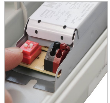
Der Leuchentreiber kann mit einem DIP-Schalter ausgestattet werden, so dass die Beleuchtung vor Ort an die jeweilige Situation im Werk angepasst werden kann.
