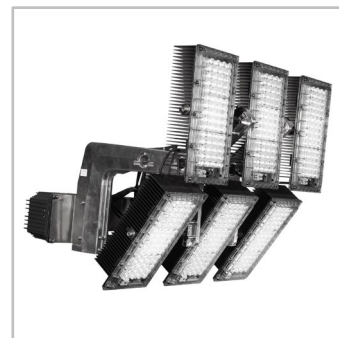
Az ECOBLAST egy moduláris megoldás, legfeljebb 6 modulal. A teljes szerkezet dőlésszöge, valamint a modulsorok dőlésszöge külön-külön állítható.
