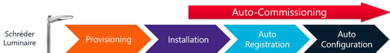
**Die Bereitstellung** eines Straßenbeleuchtungs-Steuersystems stellt sicher, dass nur bekannte Geräte berechtigt sind, sich mit dem System zu verbinden (d. h. diejenigen, die vom Schröder-Werk bereitgestellt werden und in der Asset-Datenbank registriert sind).
