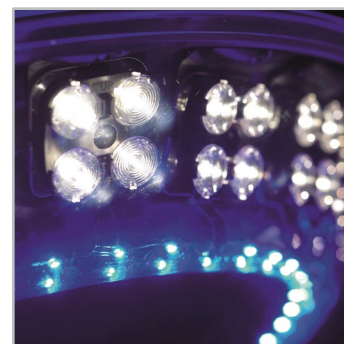
Os 64 HP LEDs brancos, distribuídos por 16 módulos, são orientados de forma independente e inclinados de acordo com o tipo de distribuição de luz necessária.
