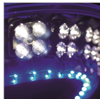
De 64 witte high-power LEDs, verdeeld over 16 modules, zijn onafhankelijk georiënteerd en gekanteld volgens het type lichtverdeling dat nodig is.
