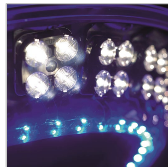
Los 64 LED blancos del alta potencia, distribuidos en 16 módulos, se orientan e inclinan independientemente según el tipo de distribución fotométrica requerida.
