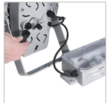
В случае чрезвычайной ситуации дополнительная автономная батарея может питать INDU BAY GEN3 в течение 3 часов для обеспечения аварийного освещения.
