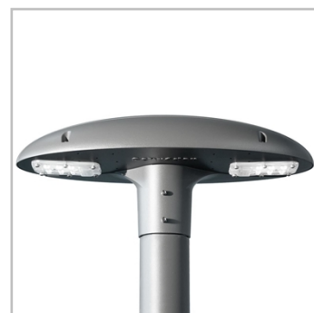
Montagem em encavadouro de Ø48-60mm, com aperto por dois parafusos M8.
