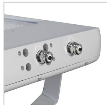
Dois buçins metálicos (entrada e saída) permitem a ligação em contínuo. Pode integrar sistemas de gestão central de edifícios (protocolo DALI 2.0 ou 1-10V).
