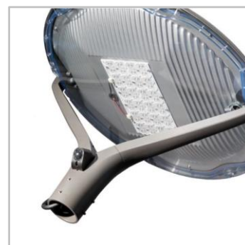
Oyo предусматривает коронарное крепление 6 винтами М8 на опору диаметром 60мм.
